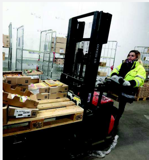
Dans le vocabulaire « logistique » gerber veut dire empiler des charges les unes sur les autres. Grâce à un chariot élévateur par exemple.
